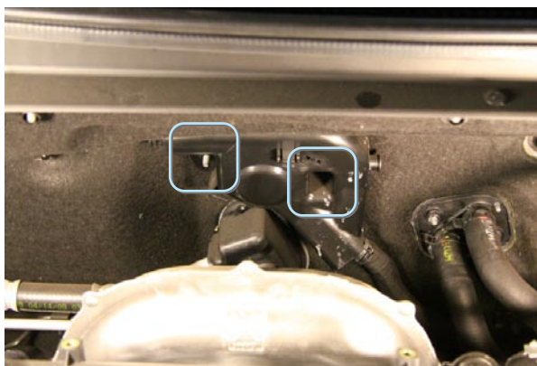
Фото 6.5. Крышка штатного уплотнения (крепление на 2 гайки М6)
