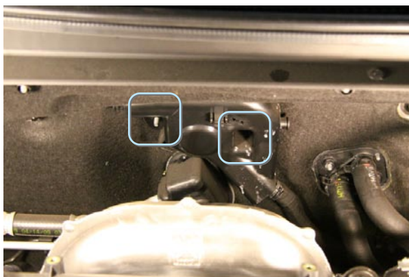
Фото 6.5. Крышка штатного уплотнения (крепление на 2 гайки М6)
