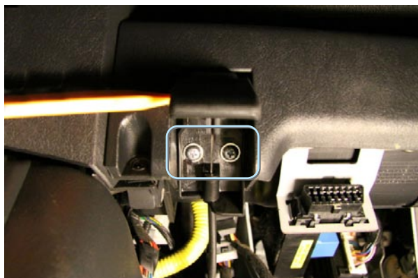
Фото 1.3. Винты крепления подторпедника
