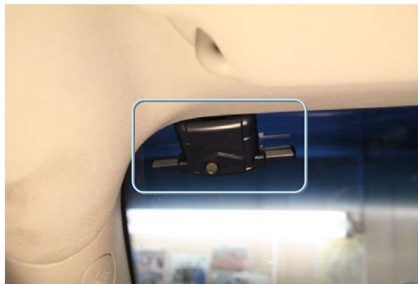
Фото 4.2. Антенна на лобовом стекле
