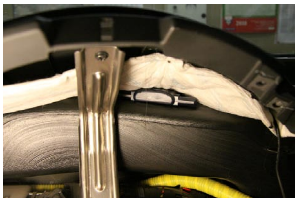
Фото 4.3. Антенна за приборным щитком
