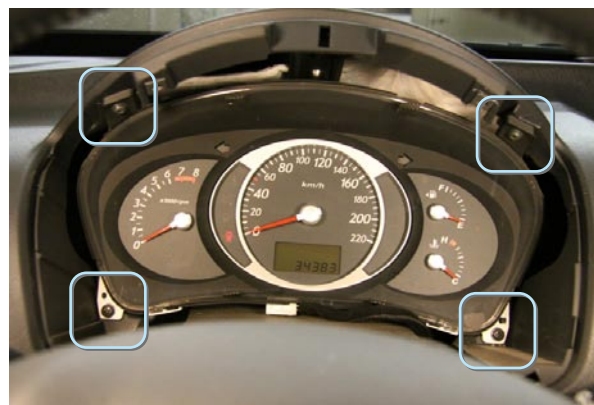
Фото 2.2. Крепление приборного щитка
