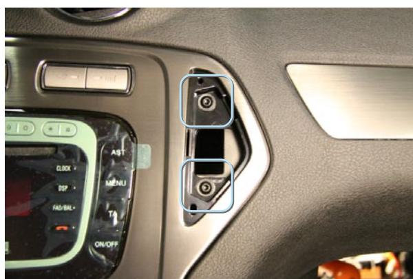
Фото 3.5. Крепление облицовки магнитолы
