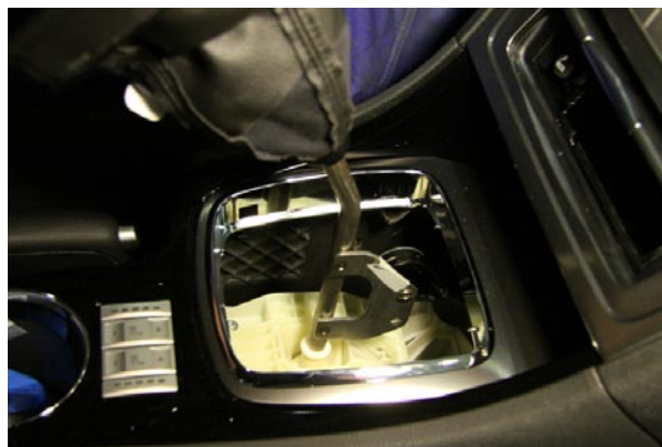
Фото 3.1. Снятие чехла рычага коробки передач
