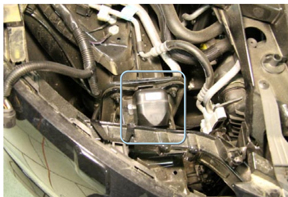
Фото 6.4. Сирена (крепление на 2 самореза)
