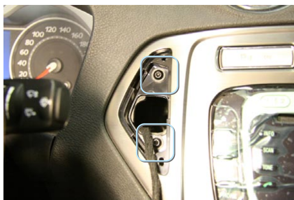
Фото 3.4. Крепление облицовки магнитолы
