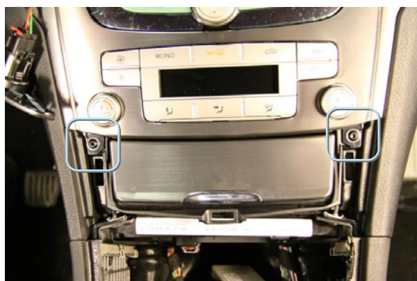
Фото 3.3. Крепление облицовки магнитолы
