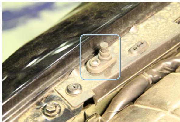
Фото 6.2. Концевик капота (отрезать 2,5 деления)
