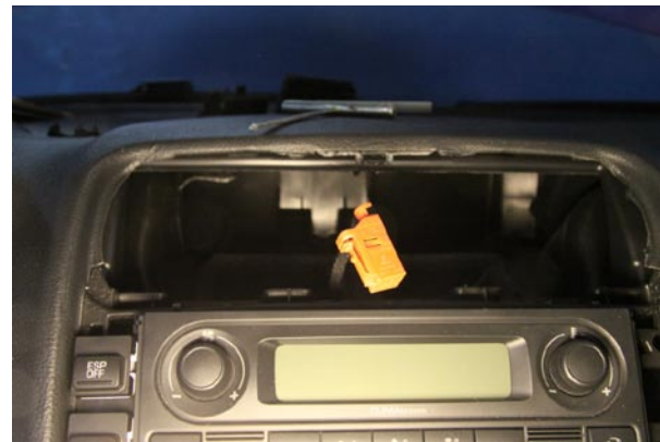
Фото 3.2. Снятие центрального дефлектора
