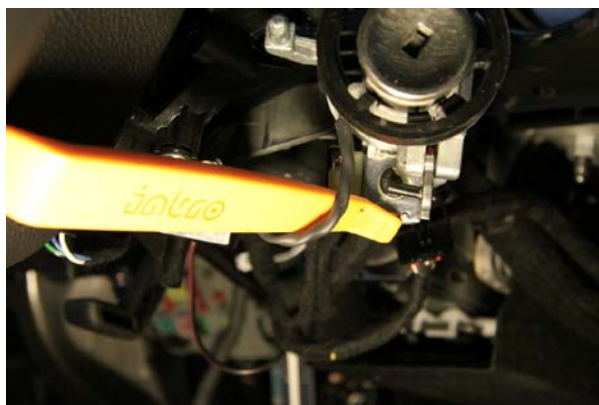
Фото 16. Провода рамки штатного иммобилайзера
