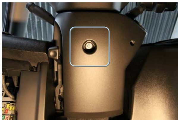
Фото 1.3. Крепление рулевого кожуха
