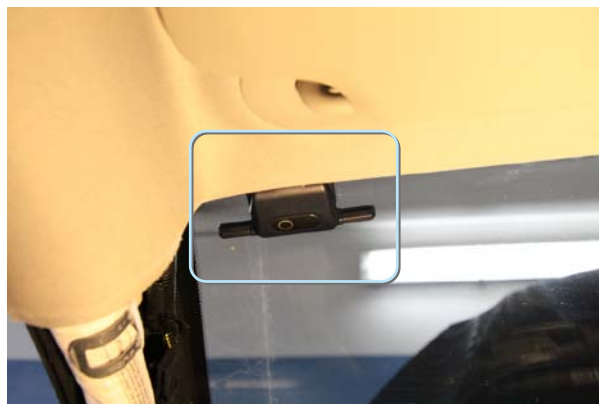
Фото 6.1. Антенна на лобовом стекле
