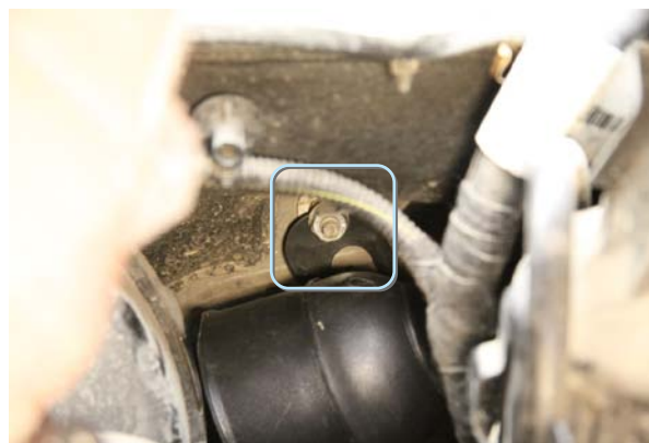
Фото 4.2. Сирена. Крепление гайкой М8
