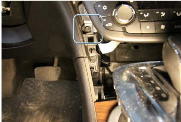
Фото 1.7. Крепление левой части центрального тоннеля
