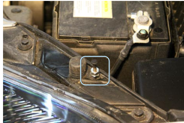
Фото 5.4. Концевик капота. Высота 27 мм.
