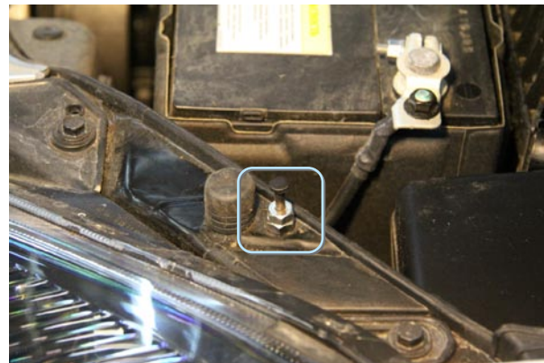
Фото 5.4. Концевик капота. Высота 27 мм.
