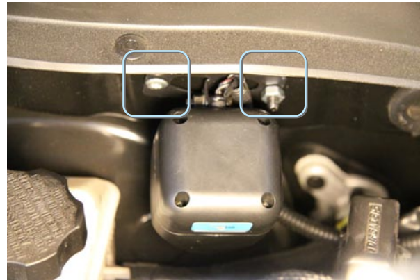
Фото 5.2. Сирена. Крепление гайкой М6 и саморезом
