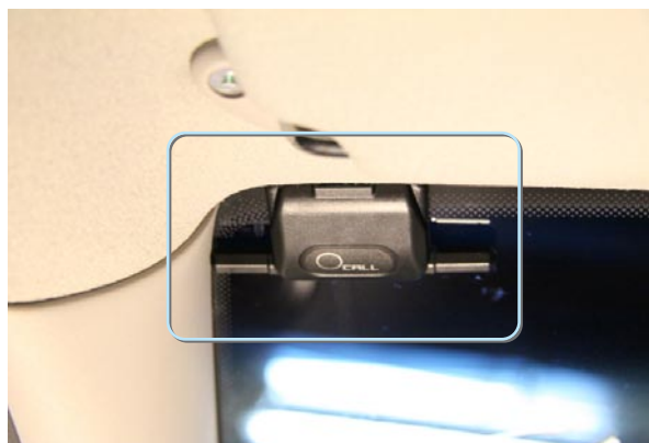
Фото 3.2. Антенна на лобовом стекле
