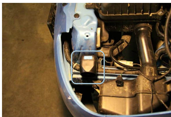
Фото 4.2. Сирена (крепление на 2 самореза)
