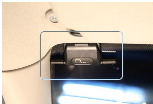
Фото 2.2. Антенна на лобовом стекле
