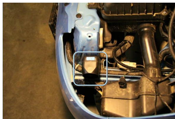
Фото 3.2. Сирена (крепление на 2 самореза)
