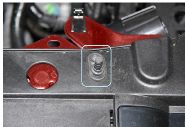
Фото 5.2. Концевик капота (отрезать 1,5 деления)
