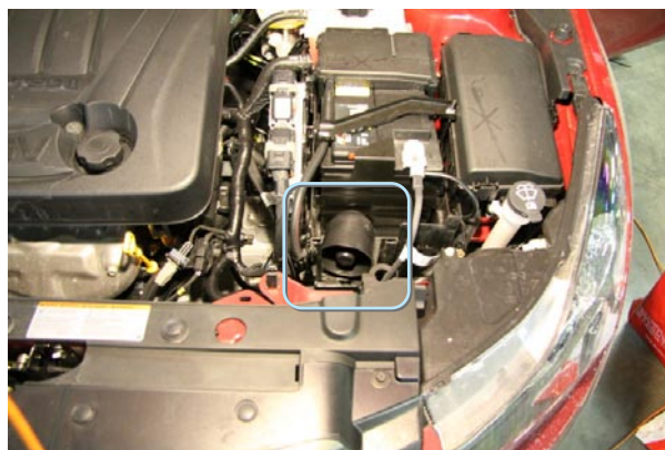
Фото 5.1. Сирена (крепление двумя саморезами)
