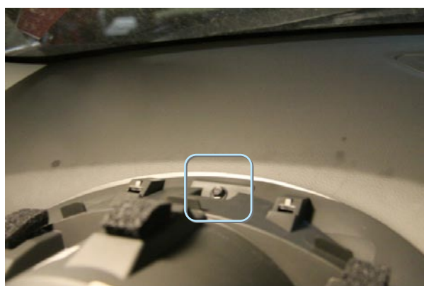
Фото 4.3. Саморез крепления приборного щитка
