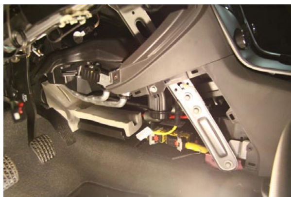
Фото 3.1. Снятие левой накладки
