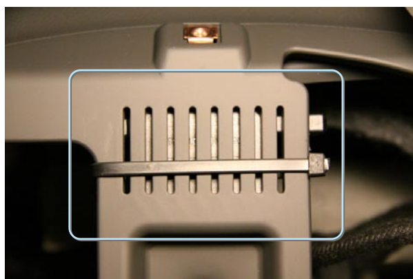
Фото 7.3. Антенна за приборным щитком
