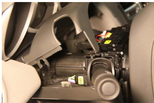
Фото 2.1 Снятие верхней части кожуха рулевого механизма
