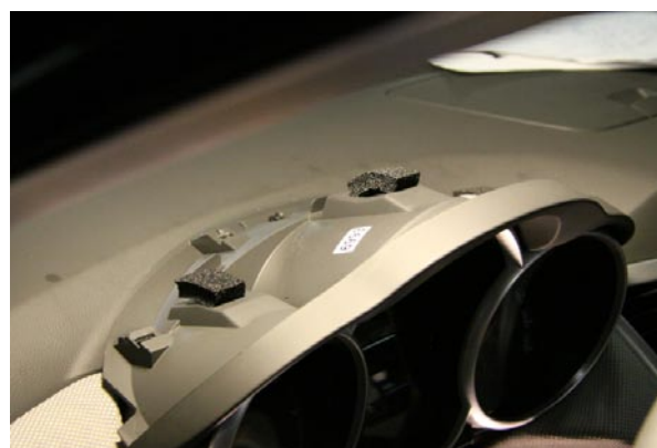
Фото 4.2. Снятие декоративной накладки
