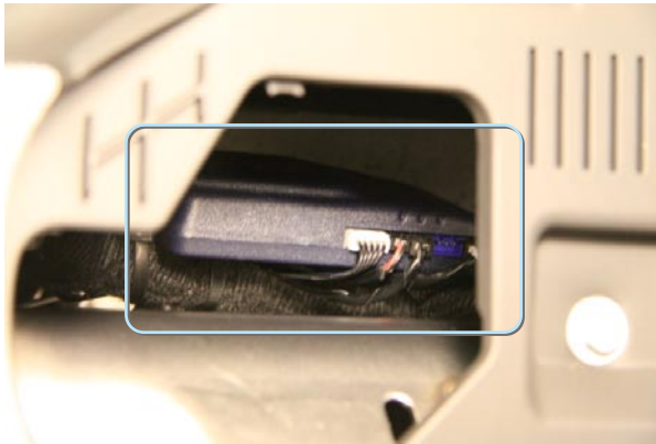
Фото 9. Блок сигнализации за приборным щитком
