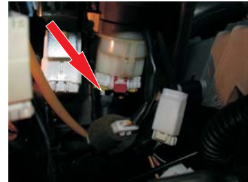
+50 На замке зажигания, БЕЛЫЙ провод
